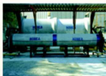
Bancada para ensaio de permeabilidade sob pressão e estanqueidade da junta
