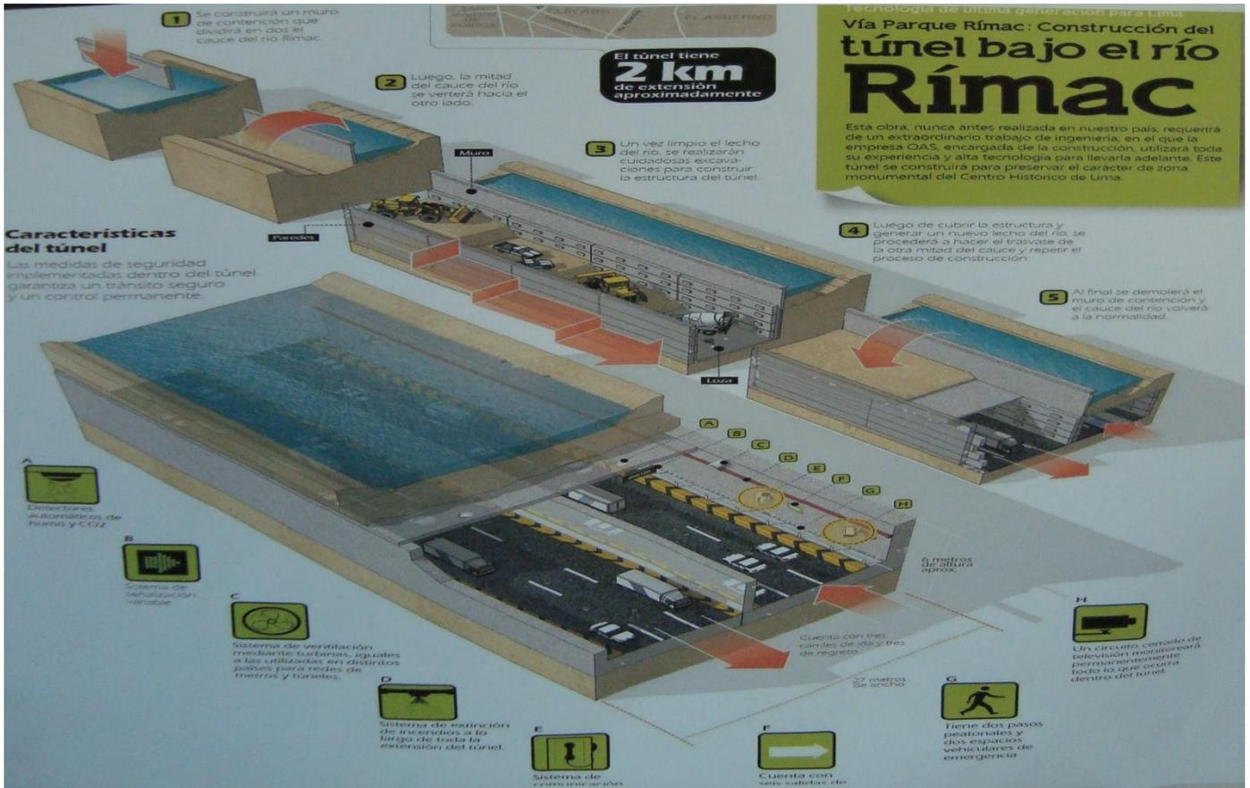
Figura 2: Modelo compartimentado com as etapas de avanço da obra, Execução do canal de desvio do rio, escavação do leito do rio e contenção dos taludes, execução do túnel tipo “Cut And Cover”, lançamento de solo compactado controlado sobre o túnel executado e recondução do rio ao seu leito.
