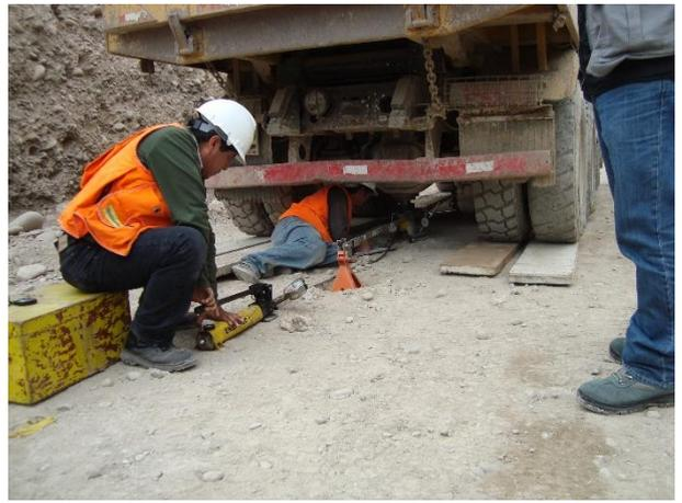
Figura 14: Ensaio de capacidade de carga do aterro.
