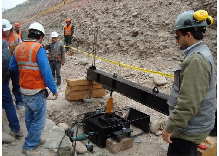
Figura 5: Execução do ensaio de cisalhamento In Situ.
