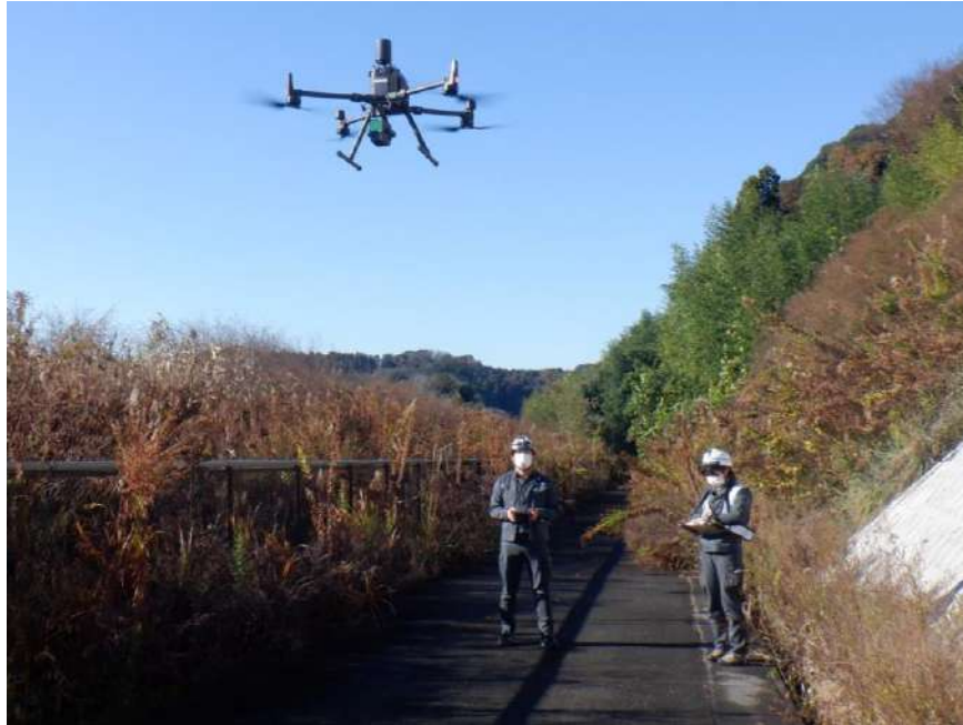
DJI Matrice300RTK 810 x 670 x 430 mm Aprox. 6,3 kg (com 2 baterias) Tempo máximo de voo 55 min.
