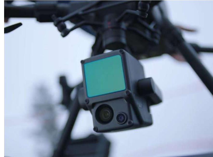
Zenmuse L1 152 x 110 x 169 mm 930g Precisão do LiDAR 3cm@100m - Medidas topográficas em hectares.
