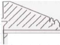
Tubulação de saída d'água muito pequena. Falta de bacia de dissipação na saída do conduto.
