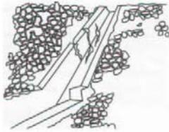
Falta de valas drenantes; falta de instalações de drenagem; drenos entupidos.
