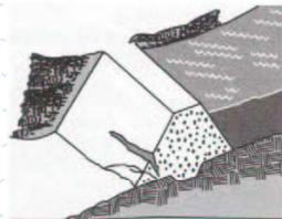
Precedidos de erosão regressiva numa porção do talude. Também podem ser encontrados em taludes muito íngremes.
