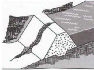
1. Material mal graduado e drenagem inadequada da crista.
