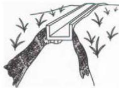
Configuração inadequada da bacia de dissipação. Materiais altamente erosivos. Falta de uma cortina de vedação no final da calha.
