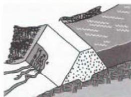
Água movendo-se através de rachaduras ou fissuras nos materiais da ombreira.
