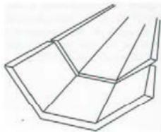
Recalque excessivo ou desigual da fundação; fuga de material da junta; junta construída muito larga e não-selada. Selante deteriorado ou removido.
