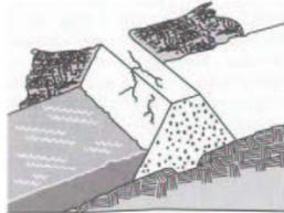
o solo perde a umidade e sofre contração, causando as rachaduras. Geralmente vistos na crista e talude de jusante.
