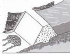
Água movendo-se rapidamente através do maciço ou fundação esta sendo controlada ou contida por um sistema gramado de raízes bem estabelecido.
