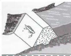
1. Falta ou perda de resistência do material do maciço da barragem.
