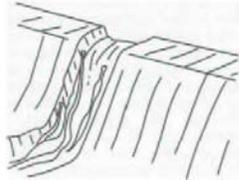
1. Rachaduras e juntas no sangradouro estão permitindo infiltração.
