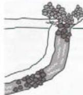
Acúmulo de sedimentos, árvores mortas, crescimento vegetativo excessivo etc., no canal do sangradouro.
