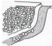
Talude muito íngreme; material mal graduado; ruptura do subleito; velocidade de escoamento muito alta; colocação inadequada do material; material do leito ou fundação levado embora pela água.
