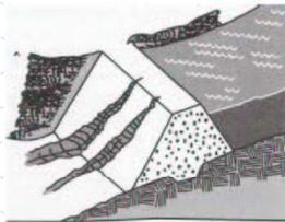
Água das chuvas carregam material da superfície do talude, resultando numa calha/vala contínua.
