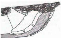
Escoamento superficial de chuvas intensas carrega material de superfície talude abaixo, o que resulta em depressões/ canais contínuos. O tráfego de animais cria erosões profundas onde a concentração de fluxo varia.
