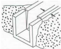
Erros de acabamento ou de mão-de-obra: assentamento desigual da fundação; pressão excessiva do aterro ou da água; reforço insuficiente das barras de ferro do concreto.
