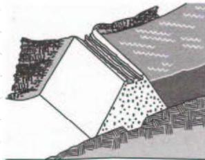
Tráfego de veículos pesados sem a manutenção adequada da superfície da crista.
