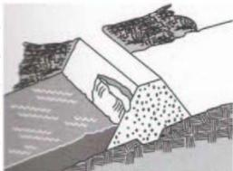
Terra ou pedras deslizaram pelo talude devido a sua inclinação exagerada ou ao movimento da fundação. Também podem ocorrer deslizamentos devido a movimentos de terra na bacia do reservatório.
