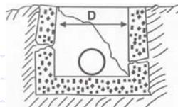
Pressões laterais excessivas ou falta de reforço na estrutura de concreto. Baixa qualidade do concreto.
