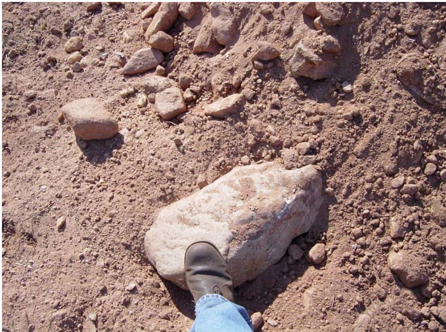
Foto 18 – Detalhe de Bloco Escavado por Slurry Shield em Obra de Coletor Tronco
